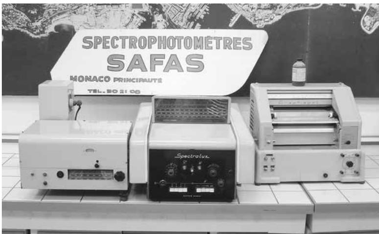
**Spectrophotomètre SAFAS Spectralux avec son module monochromateur de spectrofluorescence à lampe Xenon 450W et son enregistreur Graphispot**
